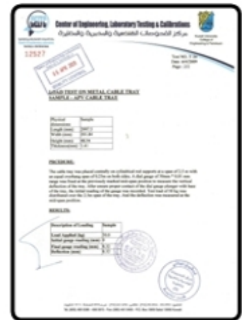
CELTC Load Test on Metal Cable Tray (2009/04/06) مركز الفحوصات الهندسية والمخبرية والمعايرة اختبار تحميل سراج كابل نري (2009/04/06)
